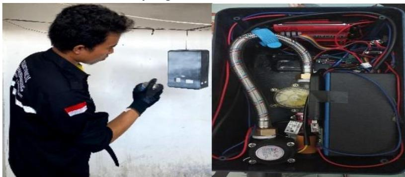
**Gambar 10.** Pembuatan case produk dan penempatan part komponen
